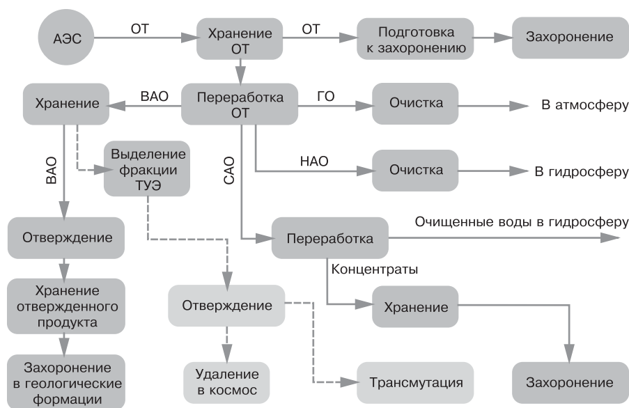
3 Схема обращения с радиоактивными отходами: ОТ – отработавшее топливо; ГО – газообразные отходы; ВАО – высокоактивные отходы; НАО – низкоактивные отходы; САО – среднеактивные отходы; ТУЭ – трансуранные элементы. Пунктир – теоретически рассматриваемые варианты
